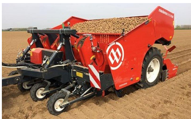
Рис.4 – Картофелесажалка Dewulf CP 42 (Голландия)
