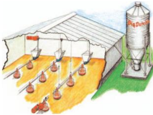
3-rasm. AugerMatic liniyalı parrandachilik uyining sxematik tasviri
