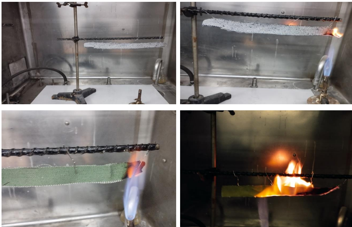
1-rasm. Mato namunasining gorizontal xolatdagi ochiq olov ta’sirida yonuvchanligini sinash jarayonlari.
