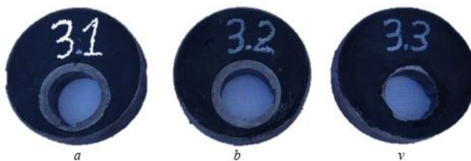
a -rezina markasi 10-220 MBS; b -rezina markasi 6308 TMKIII; v -rezina markasi 7317 MBS
