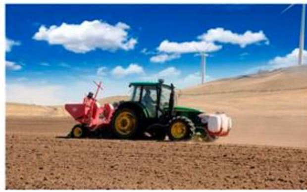
Рис.5 – Картофелесажалка Menoble 1240 (Китай)
